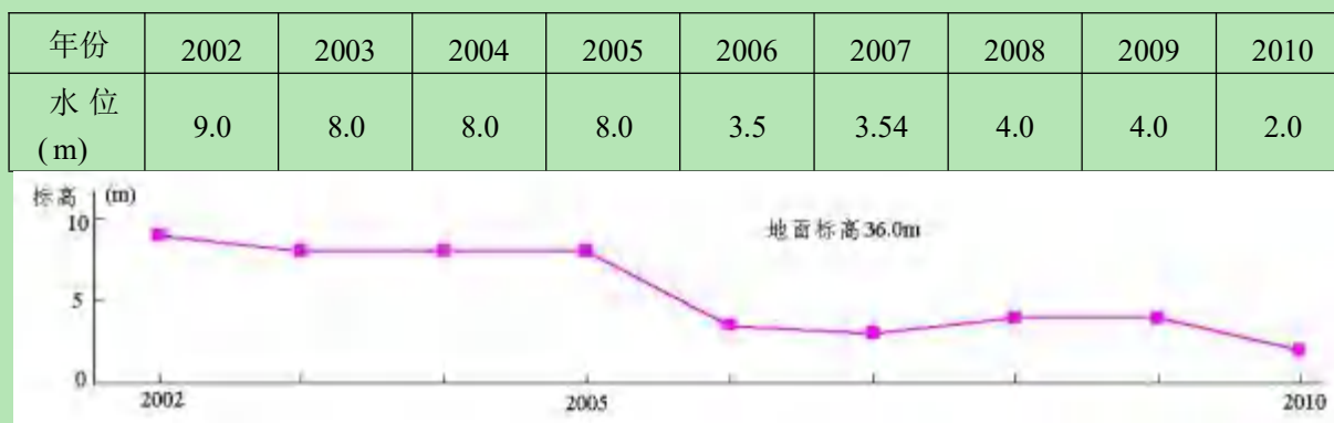
图 5.3-13 太和县自来水公司 8#井多年水位变化过程
